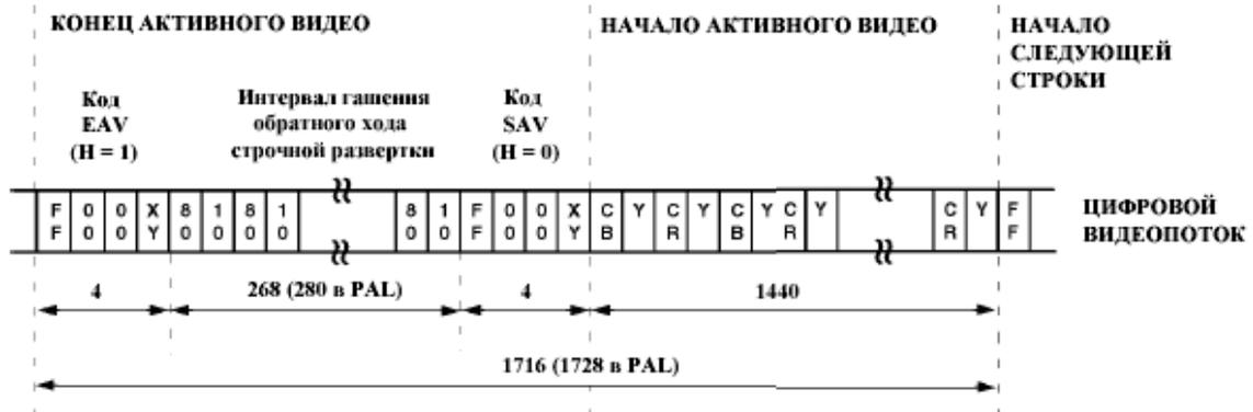
Рис. 11-6. 8-разрядный параллельный поток данных ITU-R 656 для систем NTSC (PAL)
