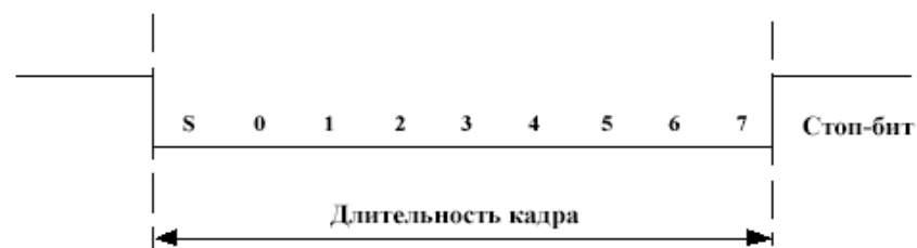
Рис. 15-21. Автоматическое измерение скорости передачи по символу 0x00
